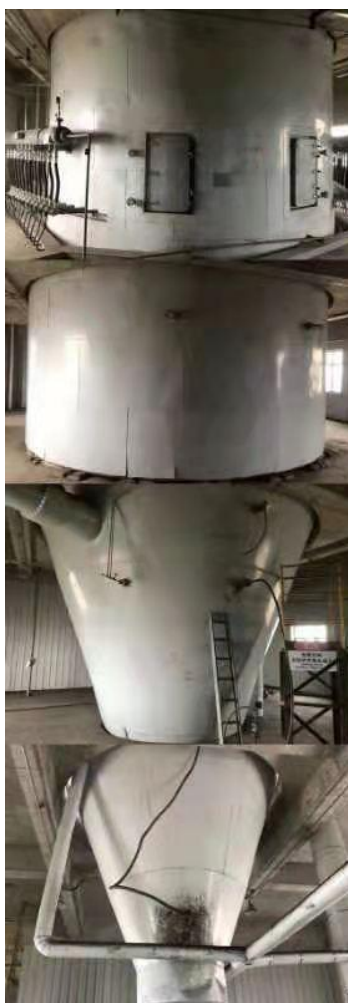
图 4.1-10 积聚袋滤器、产品输送、筛选及包装废气除尘系统
