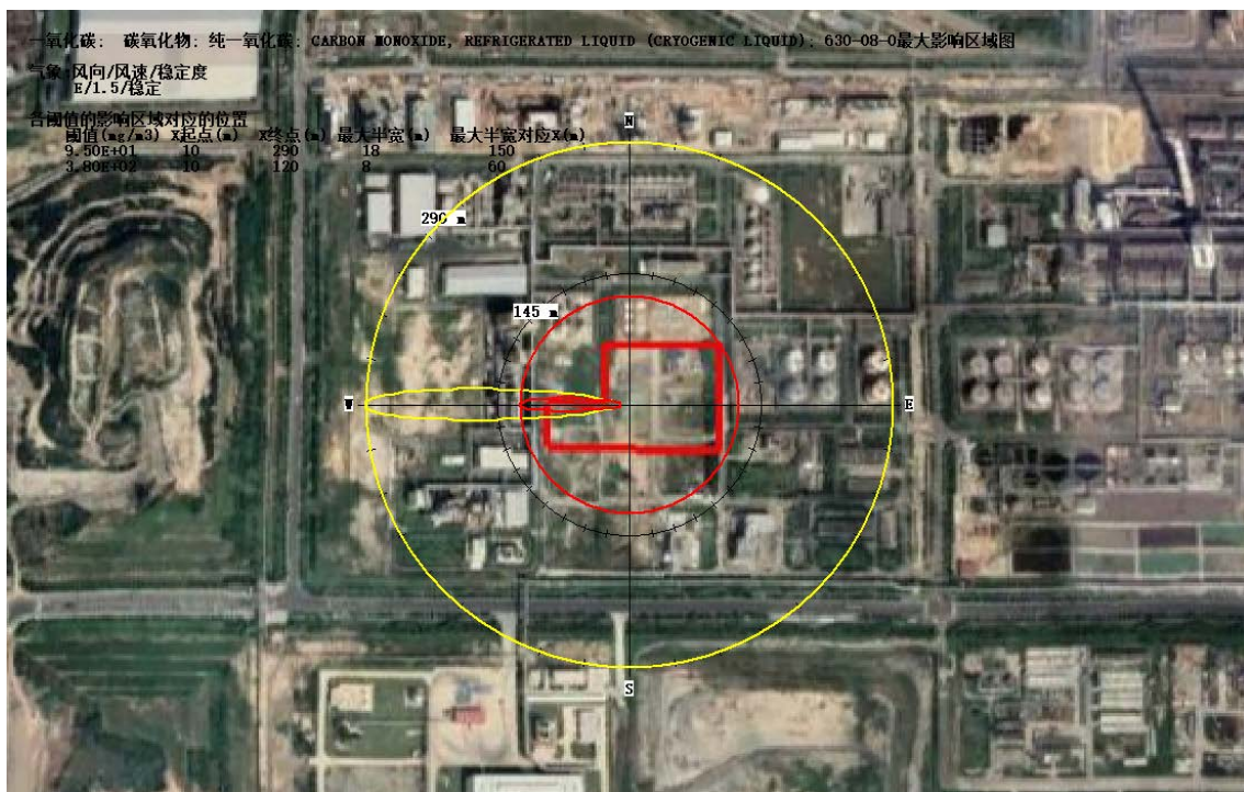
图 6.4-4 苯酐预处理罐泄漏爆炸起火引发次生 CO 事故最不利气象影响区域图
